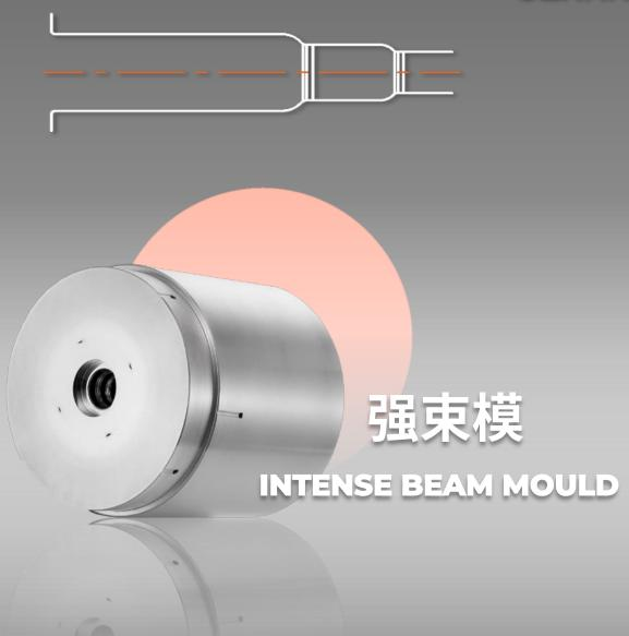
强束模的型腔结构,会使材料在通过时径向收束。由于变形量较大且一般进行多次收束, 在段差处形容易成较高应力。在保证包合力的情况下,过高的应力会影响精度及寿命。
